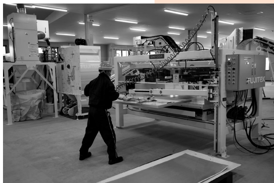
太陽光パネルリサイクル作業風景
