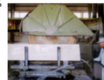
直径2.2mの大口径丸鋸機
