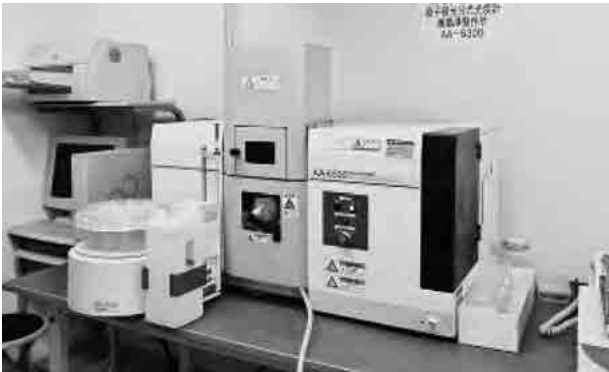
カドミウム分析機器（原子吸光分光光度計）
