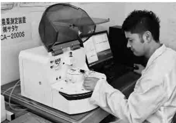
残留農薬測定機器
