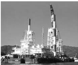
「全旋回式フローティングクレーン」
