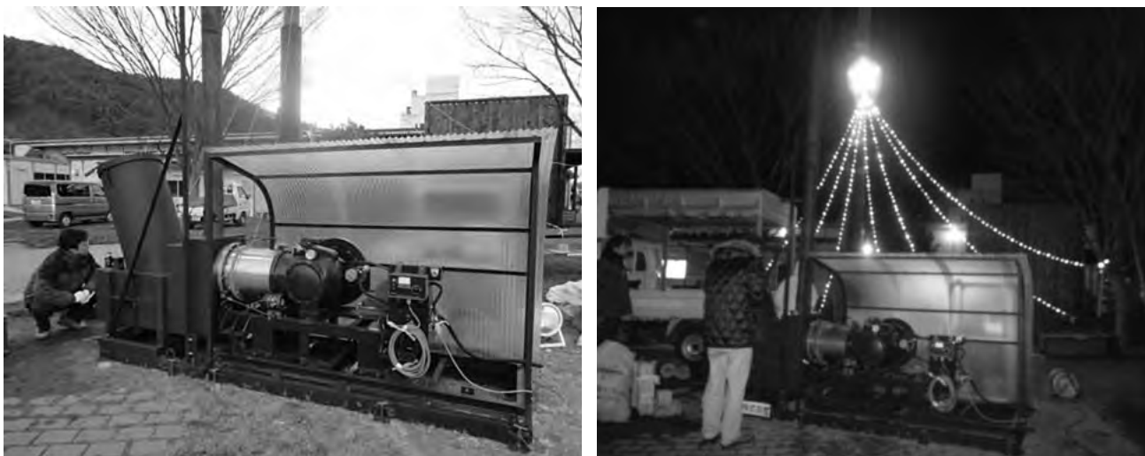
図6 震災復興関係の共同研究事例(釜石市でのスターリングエンジン活用とLED照明)
