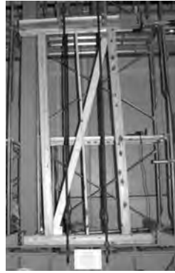
図11 構造LVL耐力壁試験
